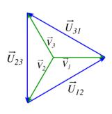
Si le réseau est équilibré :  $\dot{U}_{12} + \dot{U}_{23} + \dot{U}_{31} = \dot{0} \Leftrightarrow u_{12} + u_{23} + u_{31} = 0$ Le système des trois tensions composés est équilibré direct.
