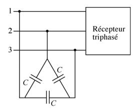
Tension aux bornes d'un condensateur : U
