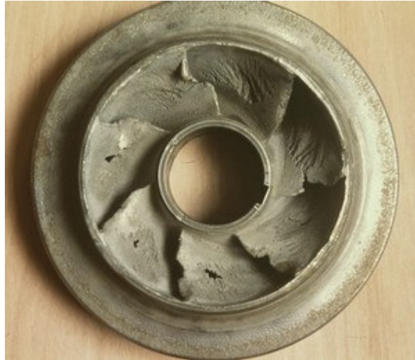
Figure 5: Effet de la cavitation sur la roue d'une pompe centrifuge
